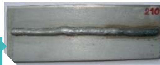
Probe aus 2101 Duplexstahl mit einer Schweißnaht Auf Entfernung von Hitze und Oxidablagerungen prüfen
