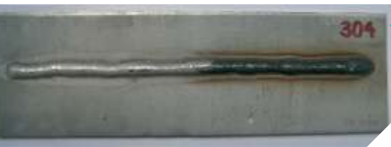
Probe aus Edelstahl 304 mit einer Schweißnaht Bewertung der Entfernung von
