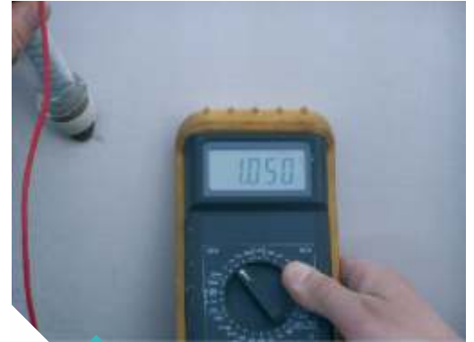
Kontrolle der passiven Filmqualität mit dem Potentialmesser
