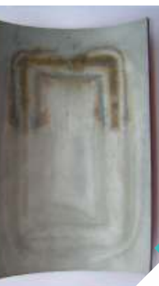
Probe aus 2205 Duplexstahl mit einer Überschweißung
